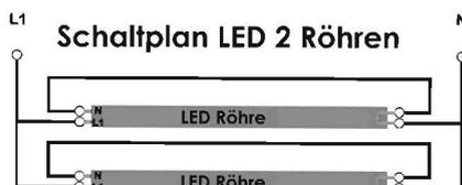
Der den Röhren evtl. beiliegende LED-Starter wird nicht benötigt.
